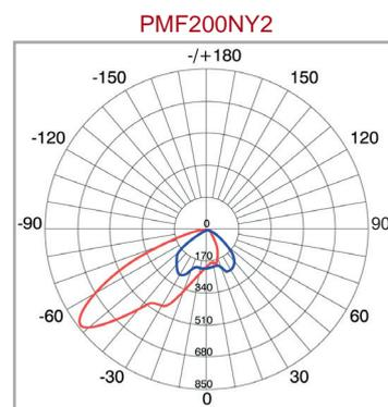
I dati fotometrici riportati nella scheda tecnica sono stati rilevati in conformità alle norme UNI EN 13032-1 e IES LM 79-08.
