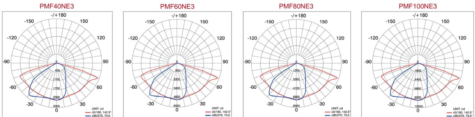
I dati fotometrici riportati nella scheda tecnica sono stati rilevati in conformità alle norme UNI EN 13032-1 e IES LM 79-08.
